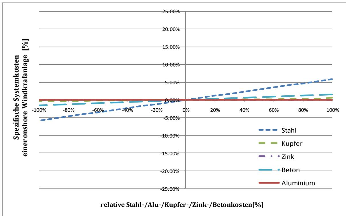
Abbildung 56: Sensitivitätsanalyse der spezifischen Systemkosten einer onshore Windkraftanlage in Abhängigkeit der Stahl-, Aluminium-, Kupfer-, Zink-, und Betonkosten
